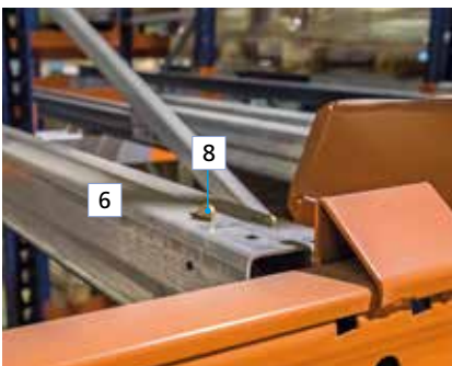
Chariot PB (6) et goupille de sécurité (8)
