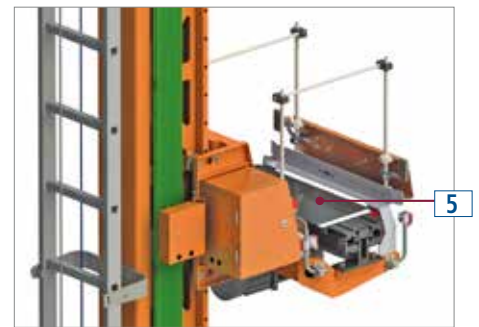
Plate-forme ou châssis mobile de levage (5).
