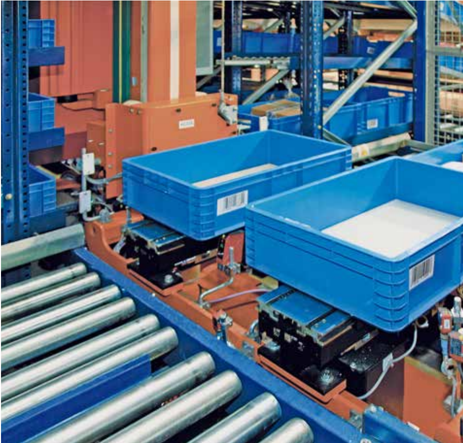
Extracteur à pelles permettant d'extraire deux caisses simultanément.
