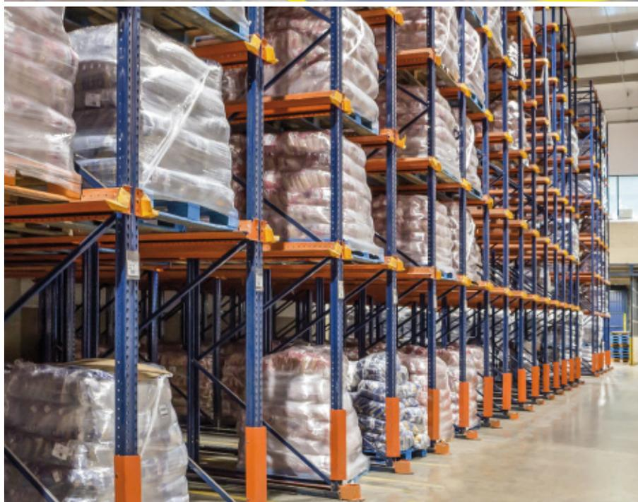
À l'aide de chariots à mât rétractable, les opérateurs pénètrent à l'intérieur des allées avec la charge légèrement surélevée et la déposent à l'emplacement souhaité. Des rails de guidage installés au sol permettent le centrage des chariots et leur circulation en toute sécurité dans les allées, tout en réduisant au maximum les risques d'accidents pouvant endommager les rayonnages.
