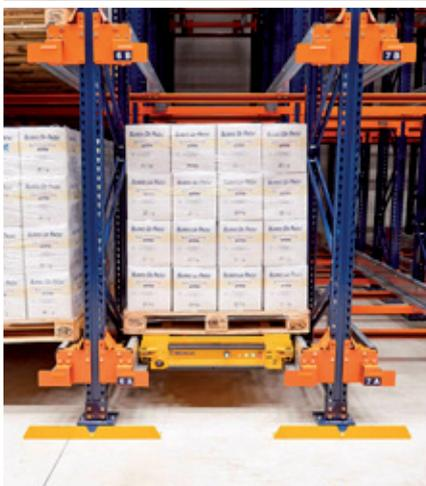
Le fabricant de beurre Burro de Paoli a équipé ses deux chambres frigorifiques en Italie avec le système Pallet Shuttle semi-automatique. La solution de stockage installée permet d'augmenter la productivité, d'accueillir 1 494 palettes et de minimiser la main-d'œuvre.
