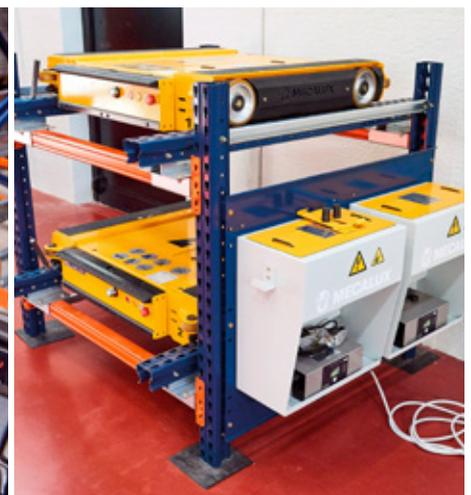
sont extraites des navettes et sont connectées par simple emboîtement aux bornes de charge situées à côté des quais.
