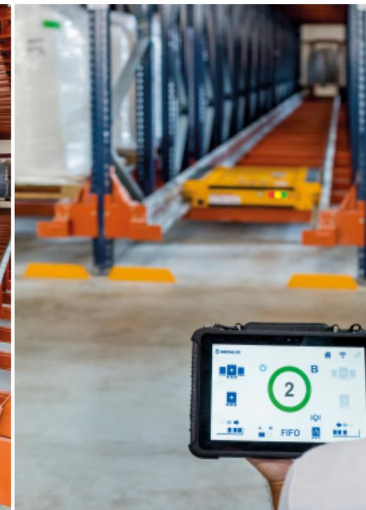
notamment par le fait que les entrées de matières premières comme les sorties de produits finis soient gérées dans un même bloc. Le logiciel dirigeant le Pallet Shuttle de Mecalux permet un contrôle et une sécurité accrus des entrées et sorties des palettes.
